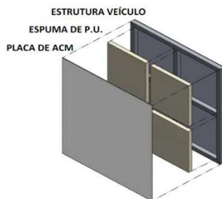
Paredes, teto e divisórias, deverão ser revestidas de painéis de alumínio composto (ACM) com 3mm de espessura, com resina a base de Fluoreto de Polivinilideno (PVDF) sobre alumínio de alta resistência e núcleo de polietileno de baixa densidade / núcleo mineral não-combustível.
